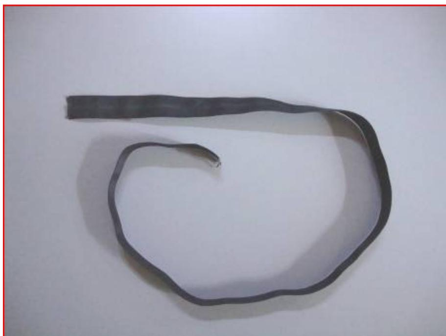
*Sezione di tubo geotessile essudante*
